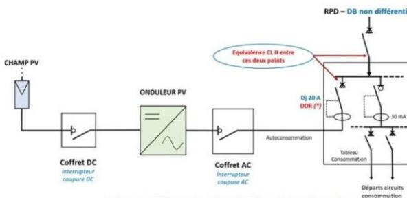
Exemple 2 = avec mise en œuvre d'un DDR dans le coffret AC de l'IP / PV et respect de l'équivalence à la CL II entre les bornes avales du DB at les bornes avales du DDR protégeant l'IP PV.
