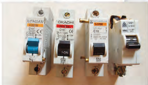
Photo de matériel contrefait et d'équipements non conformes
